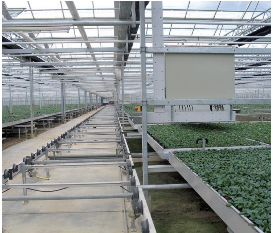
600 Meter lang ist der Weg vom einen zum anderen Ende des Betriebes. Die Zuführbahn ebenso wie die Tische haben eine Breite von 1,60 Meter
