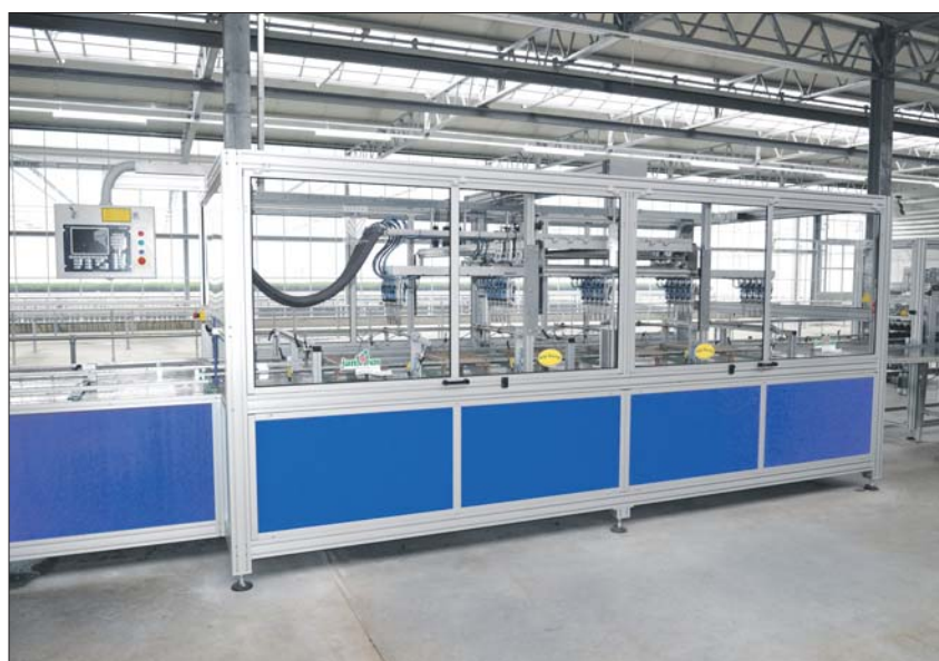
Der PC 16 Pikierroboter von Visser hat 25 Greifer mit einer theoretischen Leistung von 1.500 Pflanzen pro Stunde.
