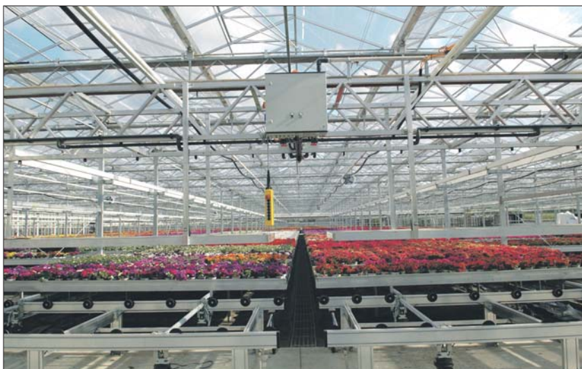
Gießwagen werden im Gartenbaubetrieb Westhoff intensiv für verschiedene Tätigkeiten, wie Gießen, Düngen, Pflanzenschutz und zum Transport genutzt.
